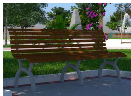
05 VISTA DOS BANCOS PÚBLICOS ESCALA: 1/50 Material: Madeira Ipê
